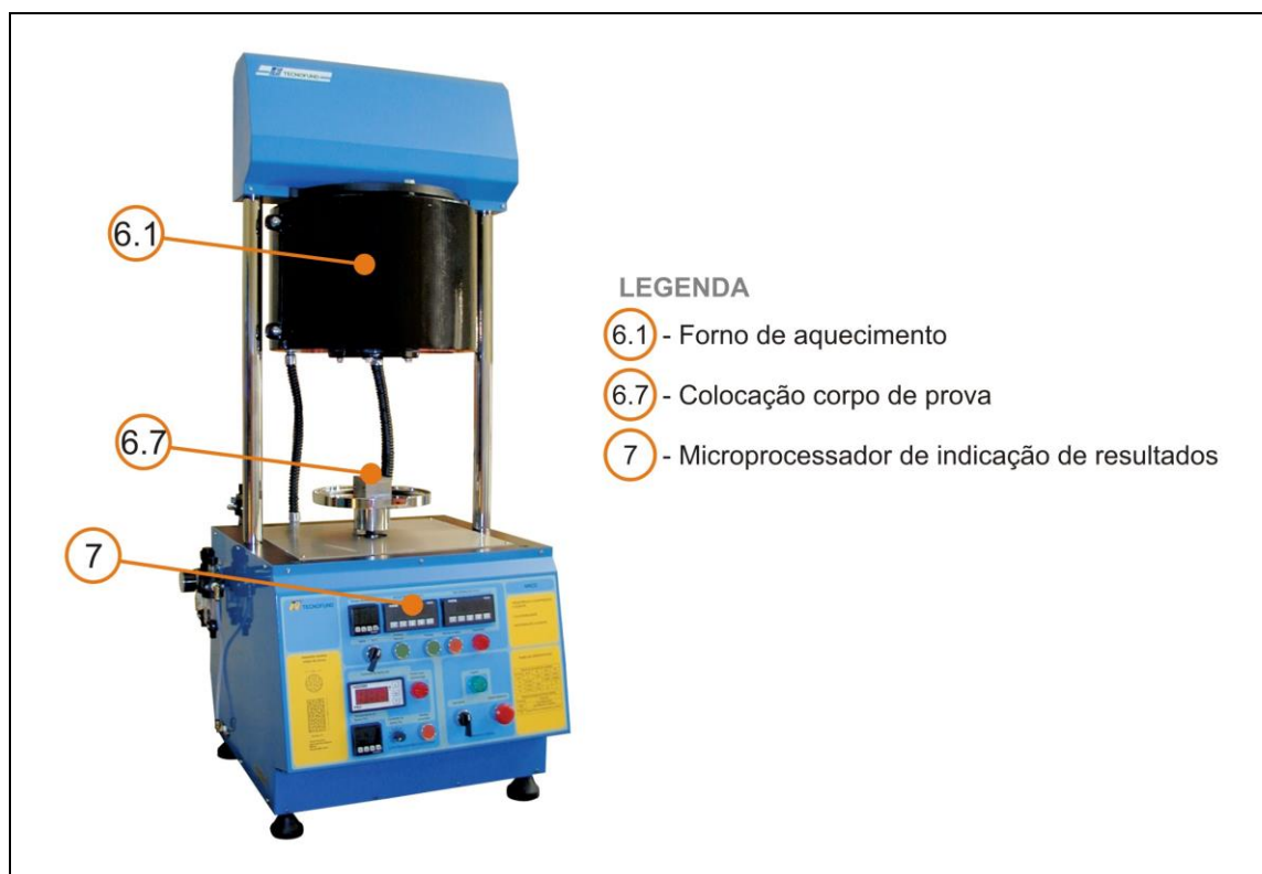
Figura 1 – Foto ilustrativa da máquina de resistência à compressão a quente.
