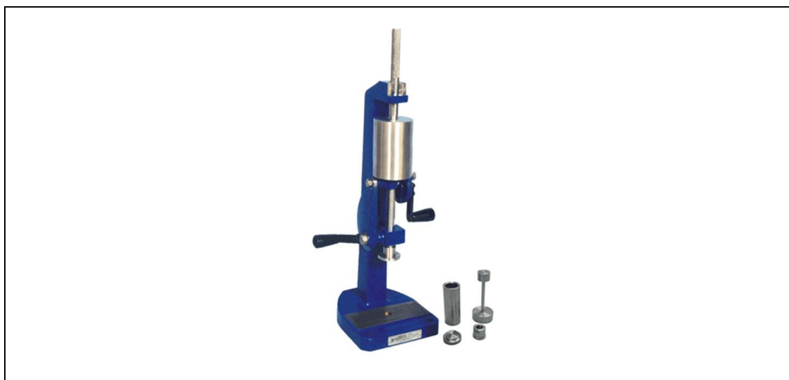
Figura 2 – Foto ilustrativa do martelete e acessórios para corpo de prova para ensaio de colapsibilidade.
